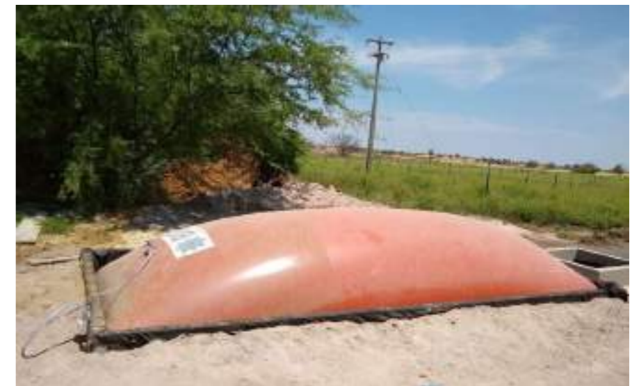
Imagem de biodigestor tipo balão.
